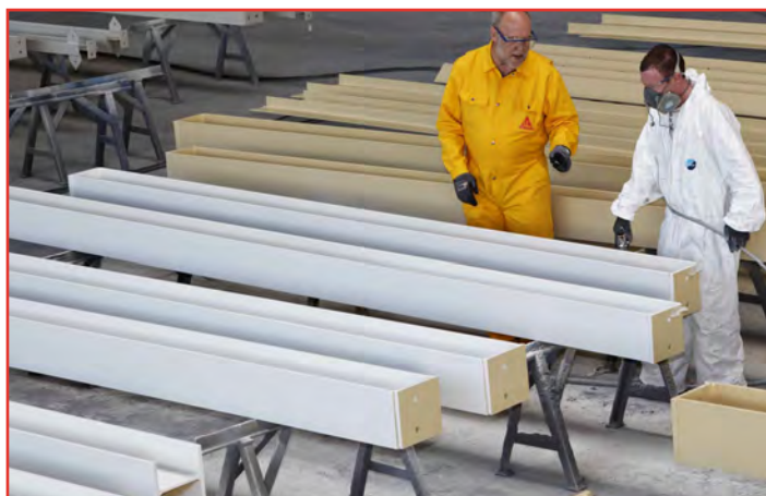
Sika-01. Die Sika Unitherm Platinum-Produkte können bereits im Werk appliziert werden und bieten im Systemaufbau Korrosionsschutz bis C5 hoch. Foto: Sika Deutschland GmbH.
