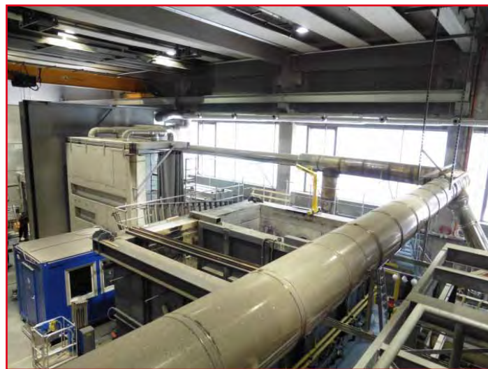
Abb. 2: moderner Deckenprüföfen der Prüf-, Überwachungs- und Zertifizierungsstelle der Stadt Wien in Wien 11 (Quelle: MA 39)
