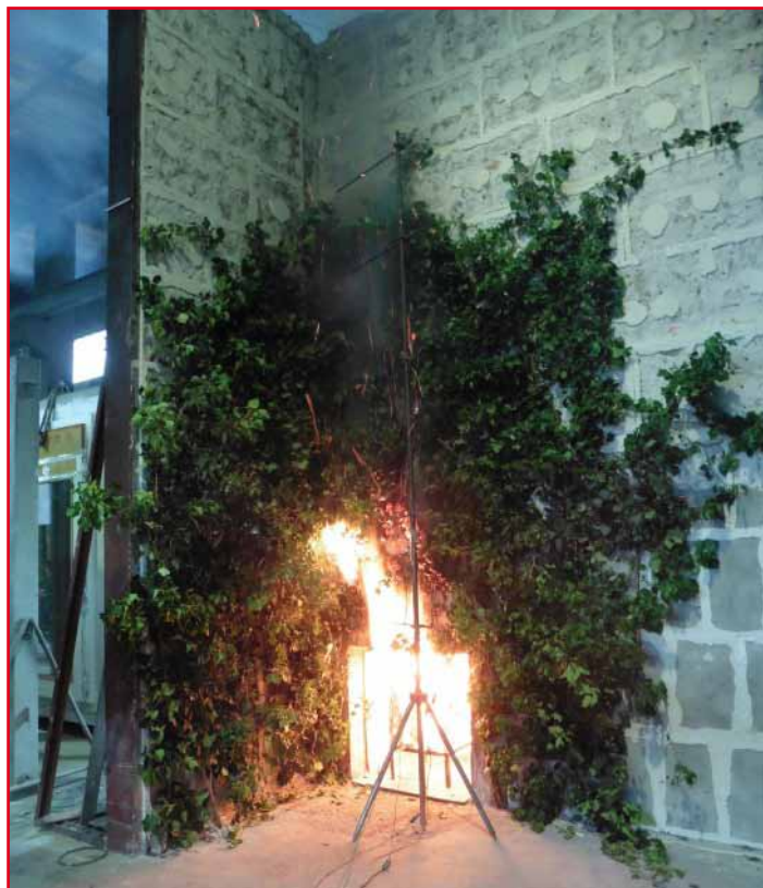
Abb.3: Fassadenbrandprüfung an einer Grünfassade (Quelle: MA39)
