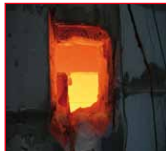
Blick in den Prüfofen während der Prüfung auf den Sturzbereich
