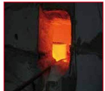
Blick in den Prüfofen während der Prüfung auf den Sturzbereich beim Ablösen eine Gipsplattenlage
